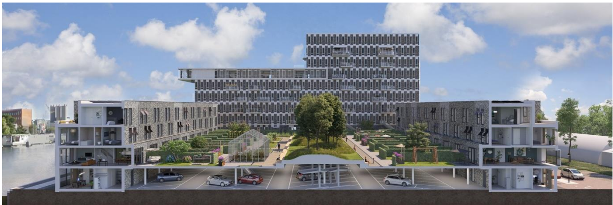
De daktuin van het project Binck Eiland in Den Haag. Boven de kolommenstructuur in het middengebied is extra gronddekking aangebracht en zijn bomen geplant.
